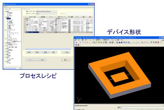
さらに、プロセスエミュレータで作成された形状から加工プロセスデータを追加することができます(新機能)。
