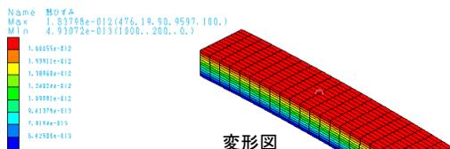
熱ひずみと変形図
